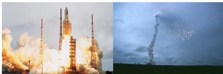
Figura 2.1: Il lancio di Ariane-5 il 4 giugno 1996; si è schiantato 36 secondi dopo il lancio a causa di una conversione di un valore in virgola mobile a 64 bit in un valore intero a 16 bit.
