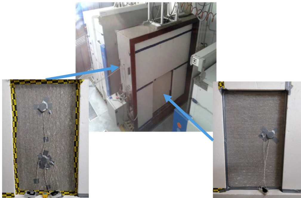
Inserimento dell'elemento da testare e posizionamento dei sensori
